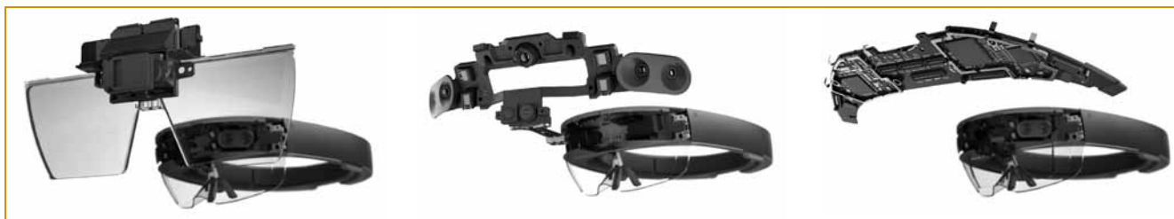
Рис. 2. Очки дополненной реальности Microsoft HoloLens: дисплей, сенсоры, аппаратное обеспечение
